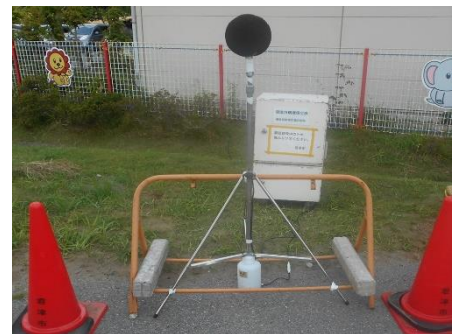
図4-4 騒音調査の様子
