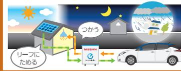
日産リーフのバッテリーはV2H (Vehicle to Home) 機器を接続すればくらしの電源に活用できます。さらに地震や台風などの自然災害による停電で、外部からの電源供給がない緊急事態の時でも、非常用電源としてお使いいただけます。
