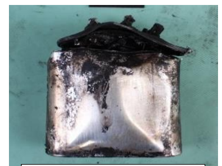
負荷がかかり 高温により破裂したもの
