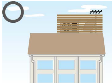
建物の屋根と調和した色彩のルーバーで、室外機やアンテナを遮蔽している
