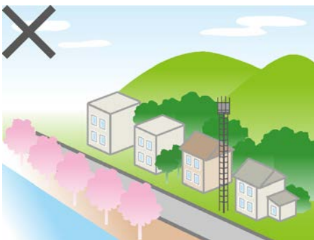
鉄塔が道路と建物に近接し、圧迫感を与えている
