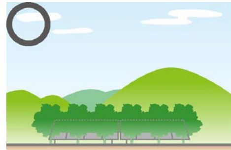
周囲に植栽を施し、遮蔽している
