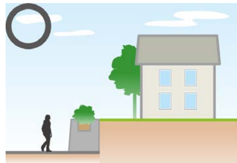
擁壁の高さ・規模を抑え、植栽を施すことで、圧迫感を軽減している
