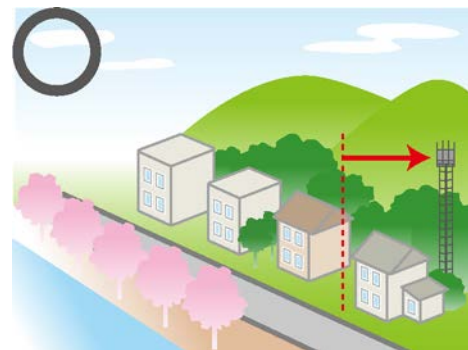
鉄塔を建物より奥に配置し、圧迫感を軽減している
